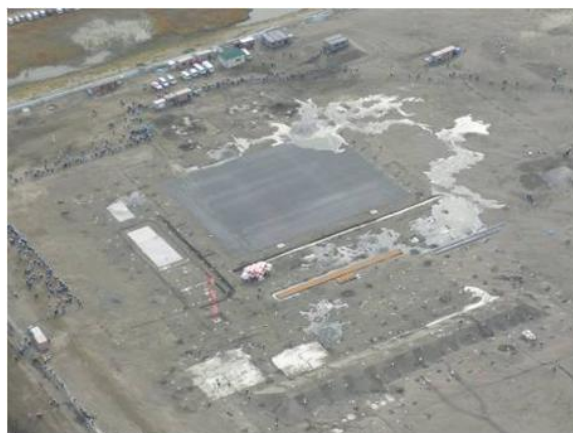
写真 1-1 液状化実験状況(発破後)
