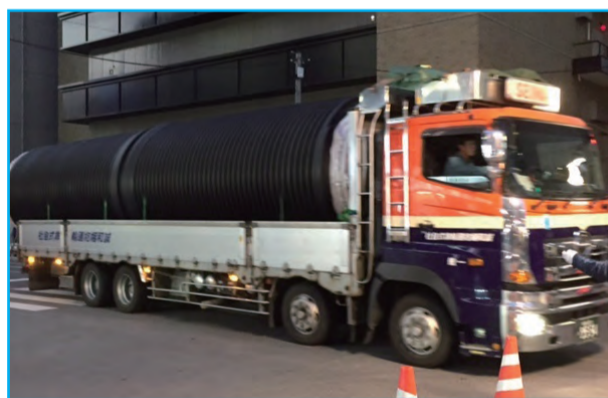
ハウエル管納入状況
